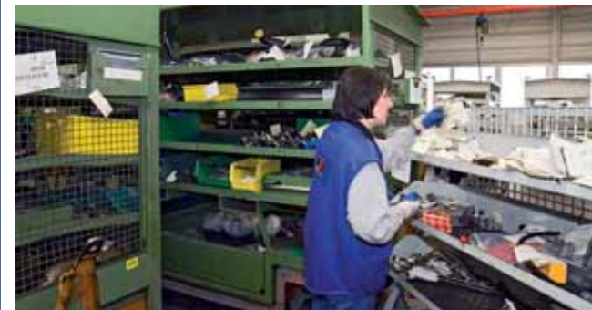
In so genannten Montageregalwagen werden sämtliche Teile aus den verschiedenen Lagerbereichen zusammengeführt: Die richtigen Teile liegen in der exakten Stückzahl an einer dafür vorgesehenen Stelle im Regal.
